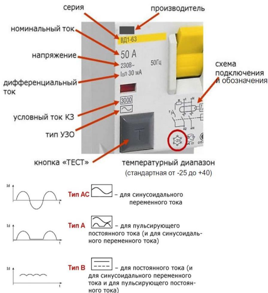
Рисунок 5. Маркировка УДТ
