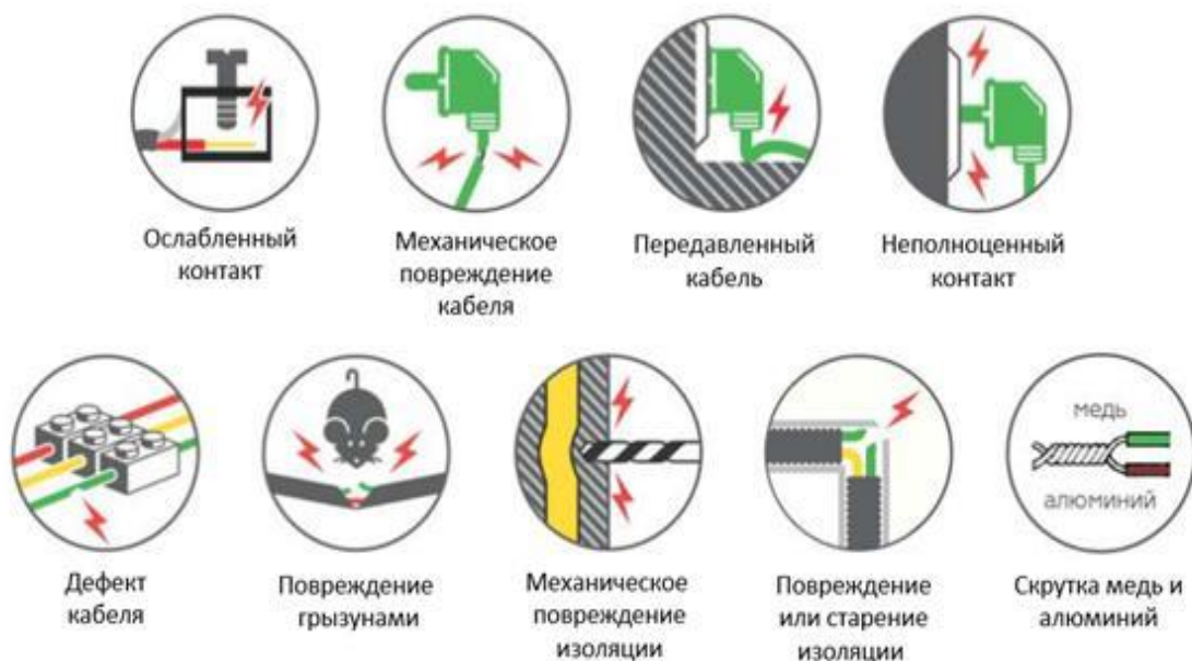
Рисунок 6. Возможные причины искрения в электропроводке
